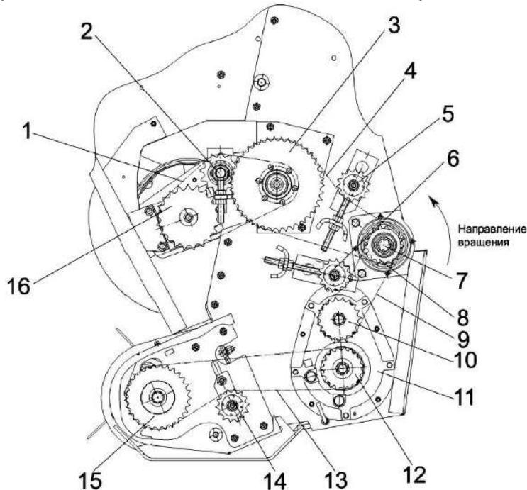
1 – цепная передача привода шнека; 2, 5, 6, 14 – натяжные устройства; 3, 8, 10, 12, 15, 16 – звездочки приводов; 4, 9 – промежуточные цепные передачи; 7 – вал контрприводной подборщика; 11 – редуктор; 13 – цепная передача привода подбирающего устройства
