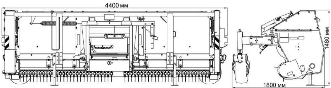
Рисунок 1.2 – Габаритные размеры подборщика
