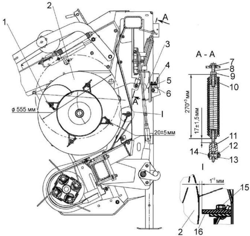
1 – лопатка; 2 – виток шнека; 3 – рычаг; 4, 9, 15 – гайки; 5 – компенсатор (пластины регулировочные); 6 – амортизатор; 7 – шайба сферическая; 8 – болт; 10 – пружина; 11 – вилка; 12 – сплинт; 13 – шайба; 14 – ось; 16 – чистик
