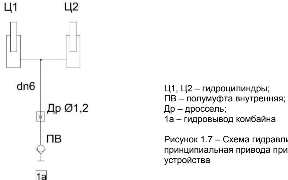
Рисунок 1.7 – Схема гидравлическая принципиальная привода прижимного устройства
