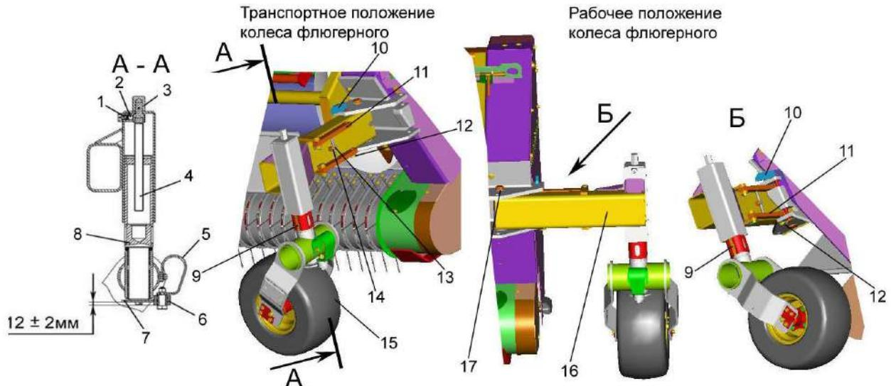
1 – пружина; 2 – шарик; 3 – наконечник; 4 – винт регулировочный; 5 – пружина; 6 – ролик; 7 – копир; 8 – ось колеса; 9 – линейки; 10 – фиксатор; 11 – упор; 12 – сплинт быстросъемный; 13 – планка; 14 – болт; 15 – колесо флюгерное; 16 – опора; 17 – ось опоры
