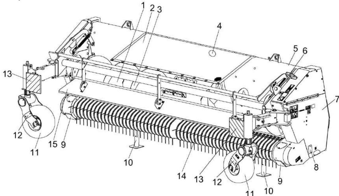
1 – шнек; 2 – защитный экран; 3 – лопатка шнека; 4 – рамка переходная; 5 – рама; 6 – фиксатор; 7 – ограждение; 8, 12 – световозвращатели; 9 – башмаки; 10 – опоры стояночные; 11 – колеса флюгерные; 13 – щитки габаритные; 14 – устройство подбирающее; 15 – устройство прижимное
