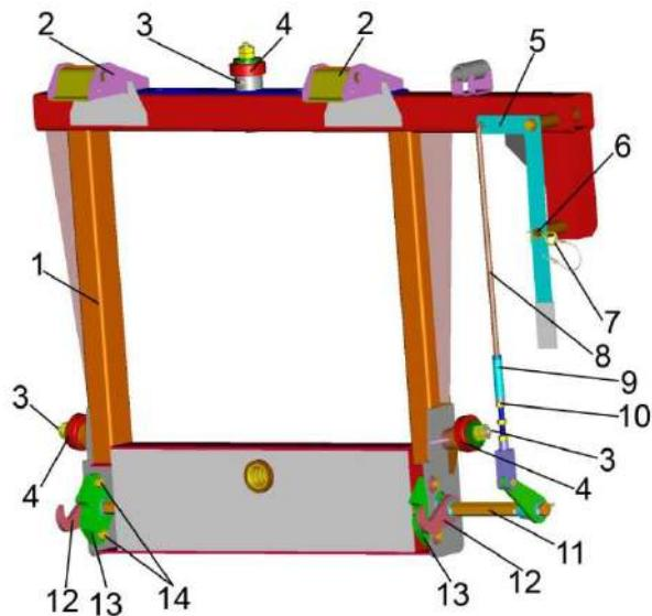
1 – рама рамки переходной; 2 – кронштейны; 3 – масленки; 4 – ролики; 5 – рукоятка; 6 – фиксатор; 7 – шплинт; 8 – тяга; 9 – стяжка; 10 – гайка; 11 – вал; 12 – крюки; 13 – ловители; 14 – гайки;
