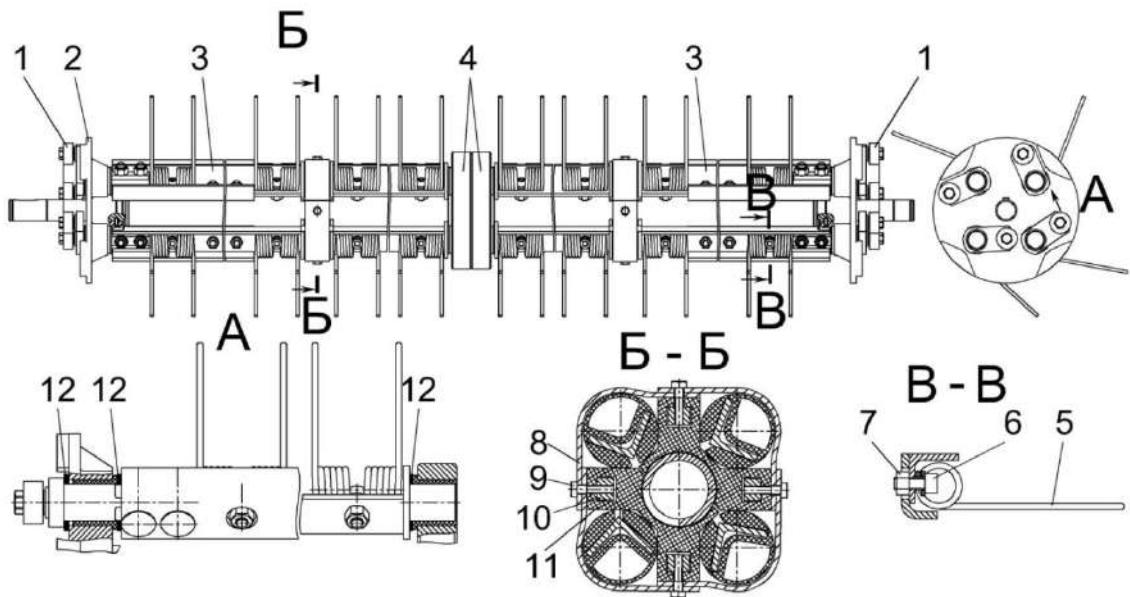
1 – эксцентрик; 2 – диск; 3 – граблина; 4 – вал; 5 – зуб пружинный; 6 – винт; 7, 10 – гайки; 8 – уголок; 9 – болт; 11 – опора; 12 – шайбы
