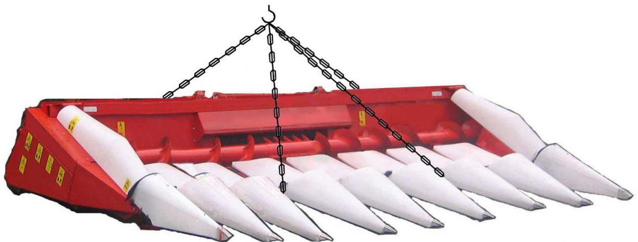
Рисунок 6.1 – Схема строповки жатки
