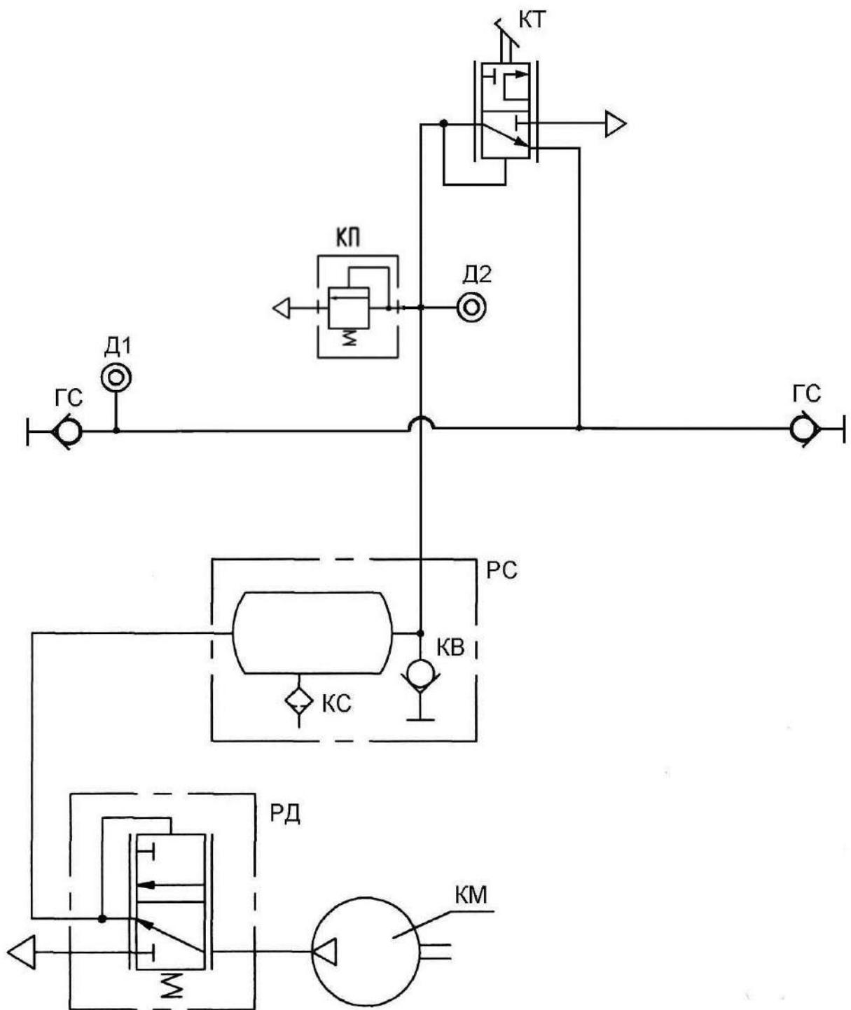
ГС – головки соединительные; Д1 – датчики сигнализатора давления воздуха; Д2 – датчик указателя давления; КВ – клапан контрольного вывода; КС – кран слива конденсата; КТ – кран тормозной; РД – регулятор давления; КП – клапан предохранительный; РС – ресивер; КМ – компрессор
