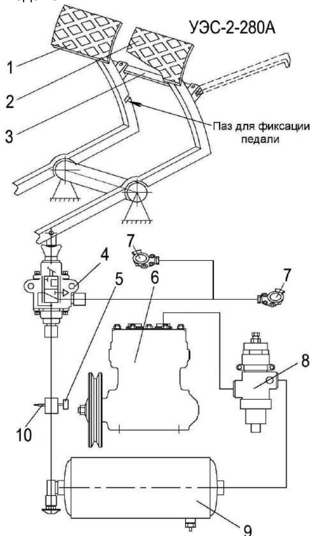
1 – педаль управления тормозами энергосредства; 2 – педаль управления пневмотормозами прицепной машины; 3 – планка фиксирующая; 4 – кран тормозной; 5 – датчик указателя давления; 6 - пневмокомпрессор; 7 – головка соединительная; 8 – регулятор давления; 9 – ресивер; 10 – клапан предохранительный
