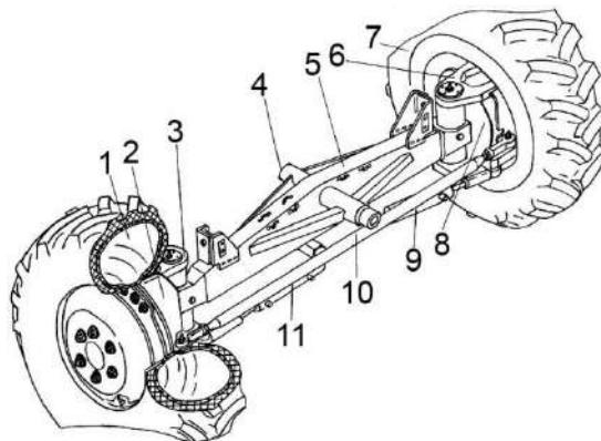
1, 7 – колёса; 2, 8 – гидромотор-колеса; 3, 6 – кулаки поворотные; 4 – ось; 5 – балка моста; 9, 11 – гидроцилиндры; 10 – рулевая тяга
