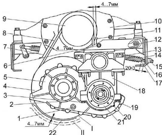
1 – контрольная пробка; 2 – крышка; 3 – болт; 4 – шкив цилиндрического редуктора; 5 – редуктор цилиндрический; 6 – болт регулировочный; 7, 11, 22 – отражатели; 8 – ременная передача; 9 – шкив двигателя; 10 – двигатель; 12 – гидроцилиндр; 13, 15, 17 – гайки; 14 – пружина; 16 – винт; 18 – опора редуктора; 19 – вал; 20 – масленка; 21 – фланец
