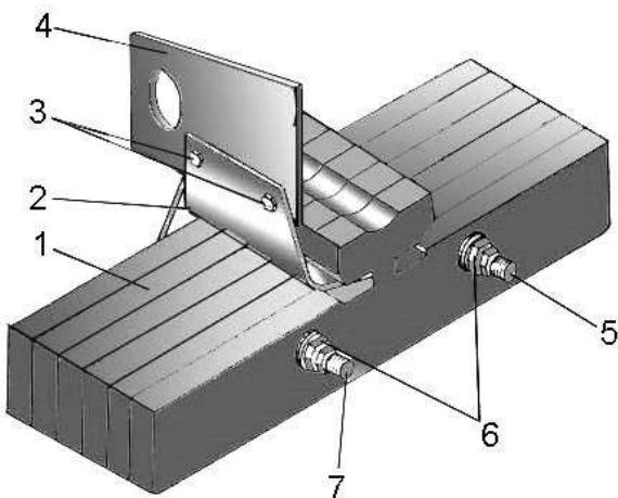
1 – противовесы; 2 – кронштейн; 3 – болты; 4 – рамка ТСУ; 5, 7 – шпильки; 6 – гайки
