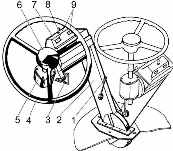
1 – рукоятка фиксации основания; 2 – основание; 3 – рукоятка фиксации конического редуктора; 4 – рулевое колесо; 5 – конический редуктор; 6 – зажим; 7 – панель рулевой колонки; 8 – переключатель указателей поворотов; 9 - контрольные лампы указателей поворотов
