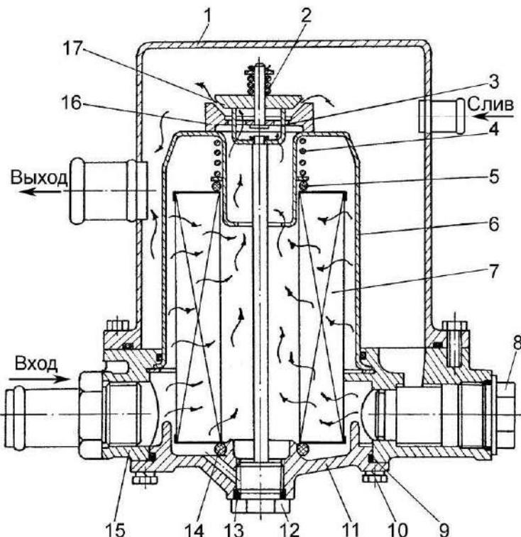
1 - корпус верхний; 2, 4 - пружины; 3 - толкатель; 5, 9, 13, 14 - кольца уплотнительные; 6 - стакан; 7 - фильтроэлемент; 8 - клапан - сигнализатор загрязнённости фильтроэлемента; 10 - болт; 11 - крышка; 12 - пробка сливная со стержнем; 15 - корпус нижний; 16 - седло клапана; 17 - клапан
