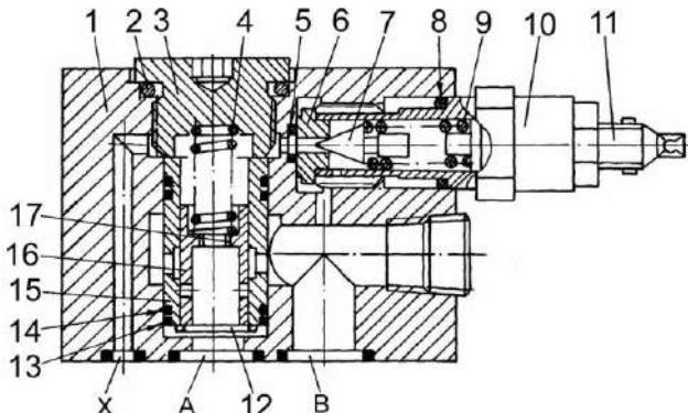
1 - корпус; 2, 5, 8, 13 - кольца уплотнительные; 3 - пробка; 4, 9 - пружины; 6 - седло; 7 - конический клапан; 10 - стакан; 11 - регулировочный винт; 12 - стопорное кольцо; 14 - кольцо защитное; 15 - гильза; 16 - клапан; 17 - дроссельное отверстие
