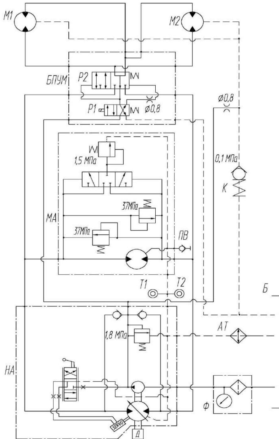
АТ – масляная секция радиатора; Б – бак масляный; БПУМ – блок подключения управляемого моста; К – клапан дренажный; МА – гидромотор; М1, М2 – гидромотор-колеса; НА – гидронасос; ПВ – полумуфта внутренняя; Р1, Р2 – гидrorаспределители; Т1 – датчик указателя температуры; Т2 – датчик сигнализатора температуры; Ф – фильтр
