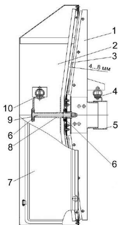
1 — пылесъемник; 2 — диффузор; 3 — сетка; 4, 10 — опоры; 5 — патрубок; 6 — втулка;
