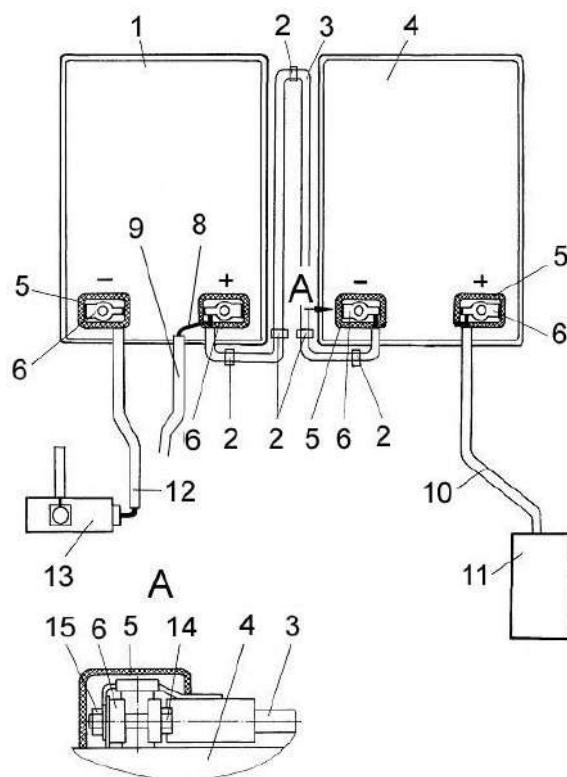
1, 4 – аккумуляторные батареи; 2 – ленты стяжные зубчатые; 3 – перемычка аккумуляторных батарей (находится в ЗИП); 5 – чехлы; 6 – наконечники жгутов; 8 - провод питания энергосредства 12В жгута задних фонарей (маркируется 84-кч); 9 – жгут задних фонарей; 10 – жгут питания стартера двигателя (маркируется «+»); 11 – стартер двигателя; 12 – жгут подключения выключателя МАССЫ (маркируется «--»); 13 - выключатель МАССЫ; 14 – болты; 15 – гайки
