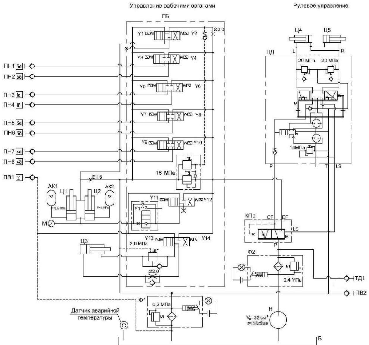
АК1, АК2 – пневмогидроаккумуляторы; Б – бак масляный; ГБ – гидроблок; КПр – клапан приоритетный; М – манометр; Н – гидронасос; НД – насос-дозатор; ПВ1, ПВ2 – полумуфты внутренние; ПН1-ПН8 – полумуфты наружные; Ф1, Ф2 – фильтры; Ц1, Ц2 – гидроцилиндры навески; Ц3 – гидроцилиндр включения ВОМ; Ц4, Ц5 – гидроцилиндры управляемого моста; ТД1 – точка диагностическая
