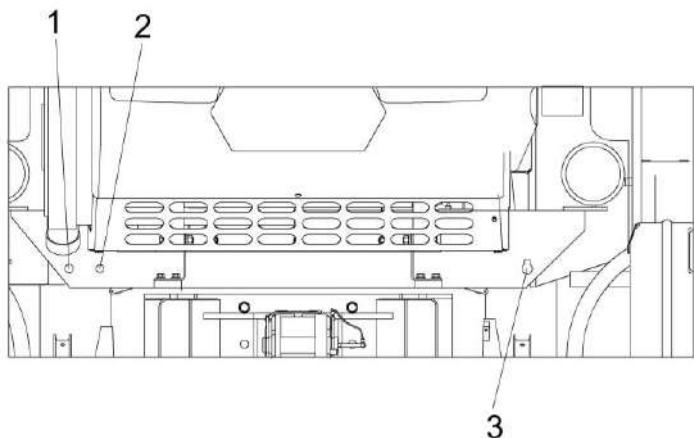
1 - соединительная головка пневмосистемы; 2 – штепсельная розетка светосигнального оборудования; 3 – заправочный гидровывод
