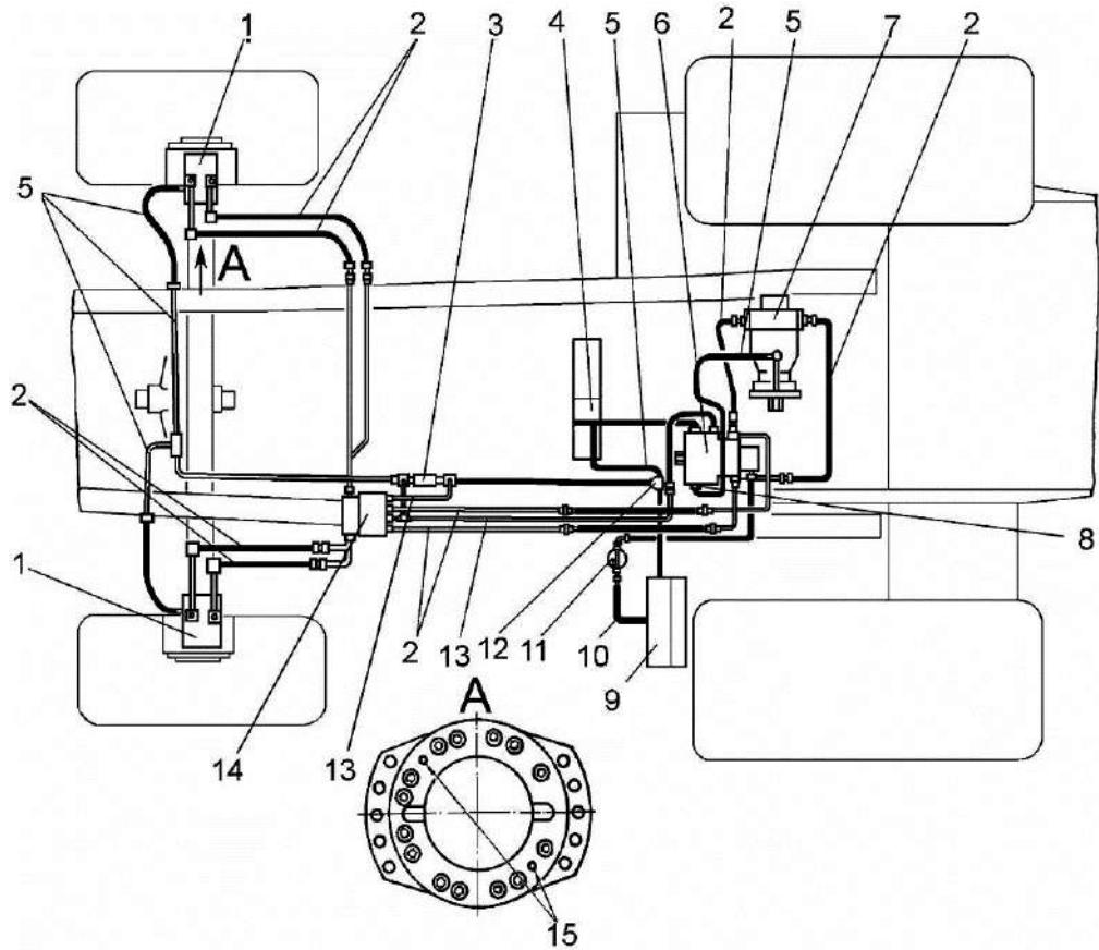
1 – мотор-колеса управляемого моста; 2 – гидролинии высокого давления; 3 – клапан дренажный; 4 – радиатор масляный; 5 – сливные гидролинии; 6 – гидронасос привода ходовой части; 7 – гидромотор привода основного ведущего моста; 8 – датчики аварийной и текущей температур; 9 – бак масляный; 10 – гидролиния всасывания; 11 – фильтр с вакуумметром; 12 – тройник; 13 – гидролинии управления; 14 – гидроблок подключения управляемого ведущего моста; 15 – воздуховыпускные винты
