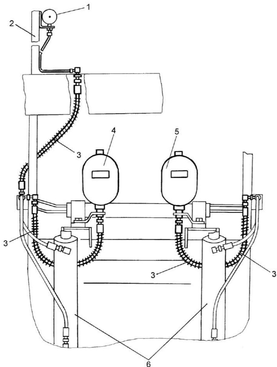
1 – манометр; 2 – кабина; 3 – рукава; 4 – левый пневмогидроаккумулятор (давление зарядки 2,5 МПа (25 кгс/см<sup>2</sup>)); 5 – правый пневмогидроаккумулятор (давление зарядки 5 МПа (50 кгс/см<sup>2</sup>)); 6 – гидроцилиндры навески
