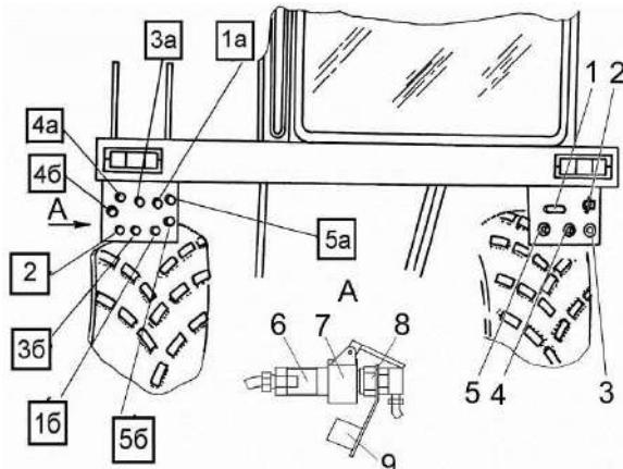
1 – розетка для подключения металлодетектора навесного комбайна; 2 – соединительная головка пневмосистемы; 3 – резерв; 4 – штепельная розетка для подключения электрооборудования сельхозмашин (12 В); 5 – штепельная розетка для подключения светосигнального электрооборудования прицепов (24 В) 6 - полумуфта наружная; 7 – фиксатор; 8 – полумуфта внутренняя (гидровывод агрегатируемого орудия); 9 – пластмассовая заглушка
