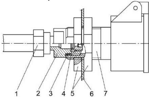
1 – трубопровод; 2 – фильтр-патрон; 3 – кольцо уплотнительное; 4 – сетка; 5 – контргайка; 6 – кронштейн кабины; 7 – полумуфта наружная
