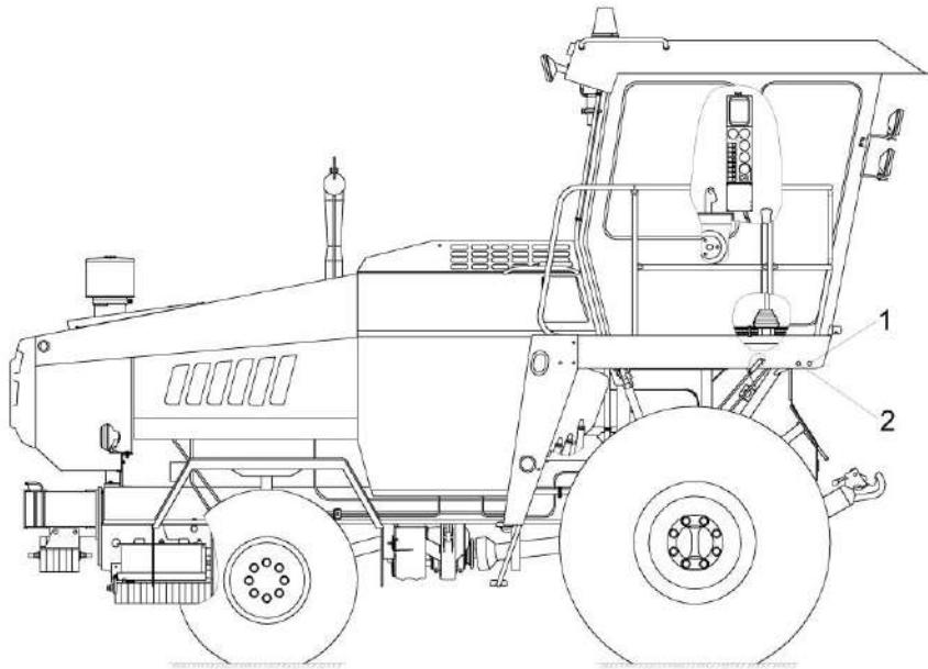
1 – кнопка опускания; 2 – кнопка подъема
