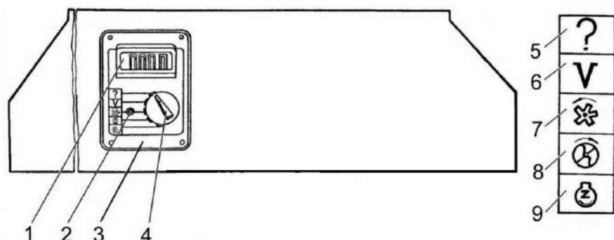
1 – индикаторное табло; 2 – кнопка записи; 3 – блок БИЧ-М; 4 – переключатель каналов; 5 – КОНТРОЛЬ (контроль исправности БИЧ-М); 6 – СКОРОСТЬ (текущее значение скорости движения УЭС); 7, 8 – резерв; 9 – ДВИГАТЕЛЬ (текущее значение частоты вращения коленчатого вала двигателя)
