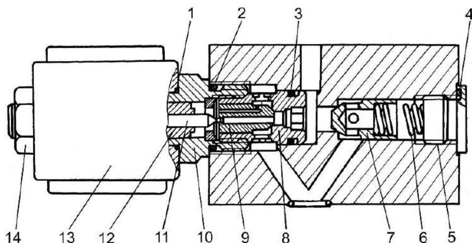
1, 2, 3, 4 – кольца уплотнительные; 5 – пробка; 6 – пружина; 7 – клапан обратный; 8 – гильза клапана; 9 – клапан; 10 – корпус; 11 – игольчатый клапан; 12 – сердечник электромагнита; 13 – электромагнит; 14 - гайка
