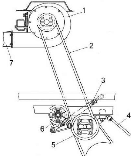
1 – вентилятор; 2 – приводной ремень; 3 – пружина; 4 – винт; 5 – привод гидронасоса ходовой части; 6 – натяжное устройство; 7 – воздухопровод
