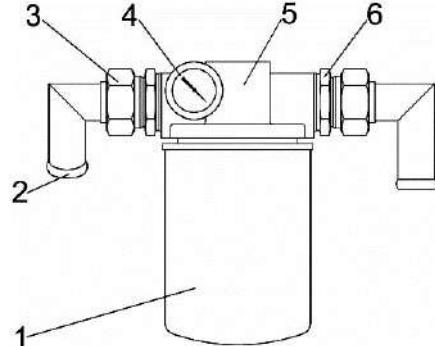
1 – фильтроэлемент; 2 – угольник; 3, 6 – штуцера; 4 – вакуумметр; 5 – корпус фильтра
