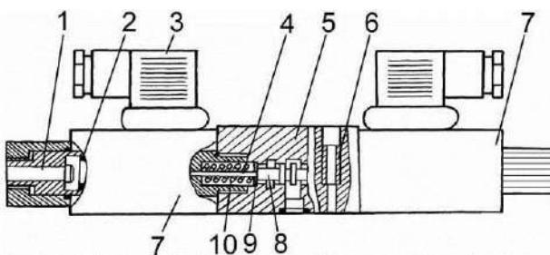
1 – аварийная (контрольная) кнопка; 2 – якорь; 3 – штепельный разъём; 4 – толкатель; 5 – корпус; 6 – втулка; 7 – электромагниты; 8 – золотник; 9 – шайба; 10 - пружина
