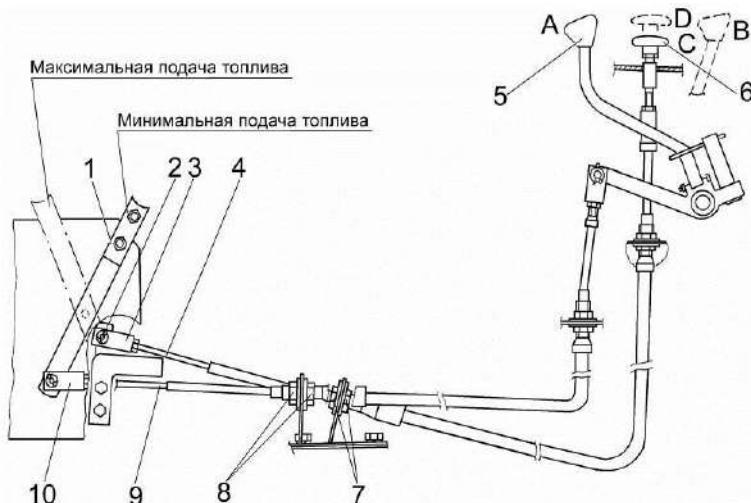
1 – рычаг топливного насоса; 2 – рычаг остановки двигателя; 3, 10 – вилки; 4, 9 – тросы; 5 – рукоятка управления подачей топлива; 6 – рукоятка остановки двигателя; 7, 8 – гайки
