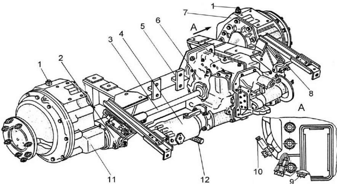
1 – сапун; 2, 8 – тормоза; 3 – полуось; 4 – гидромотор; 5 – балка моста; 6 – коробка диапазонов; 7, 11 – бортовые редуктора; 9 – сливная пробка; 10 – контрольная пробка; 12 – полумуфта заправочная
