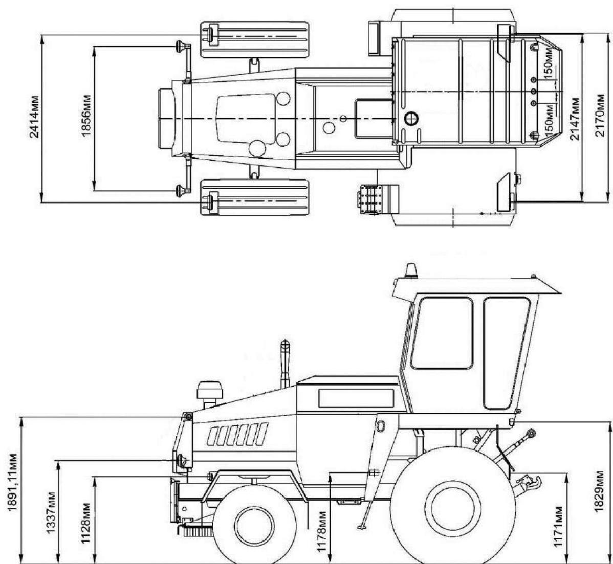
Рисунок 1.23 – Схема расположения элементов наружного освещения и световой сигнализации энергосредства
