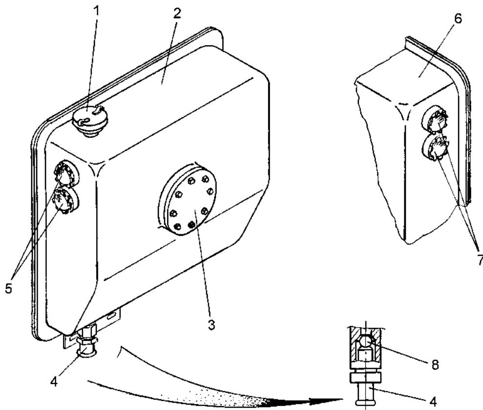
1 – сапун; 2 – бак масляный (гидросистемы ходовой части); 3 – фланец; 4 – сливной штуцер; 5, 7 – маслоуказатели (верхний и нижний); 6 – бак масляный (гидросистемы рулевого управления и силовых гидроцилиндров); 8 – шарик
